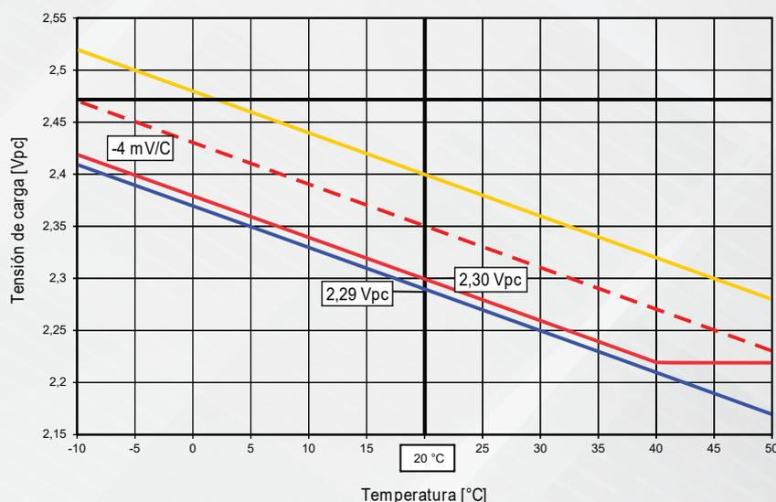
**Tensión de carga con compensación de temperatura**
