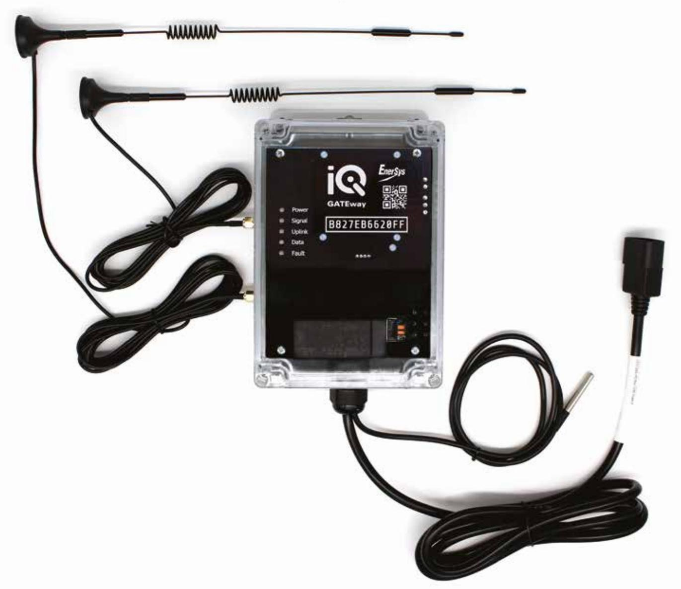
Il trasmettitore di dati della batteria iQ GATEWAY™ raccoglie automaticamente i dati da qualsiasi dispositivo di monitoraggio delle batterie iQ Mini™ che si trovi nel raggio d'azione e li carica direttamente sul portale online.
