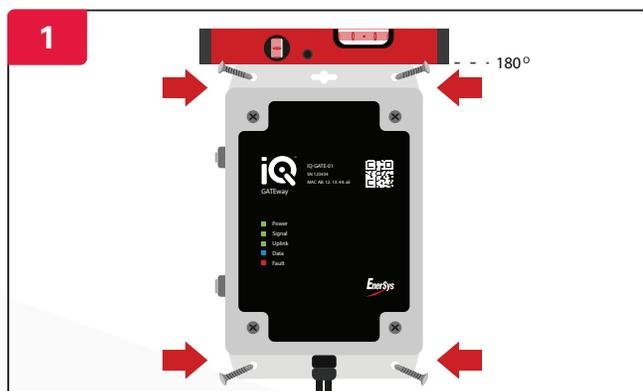
Montieren Sie die Steuerbox mit vier Schrauben/Dübeln und einer Wasserwaage an der Wand. Vergewissern Sie sich, dass die Steuerbox fest an der Wand befestigt ist.
