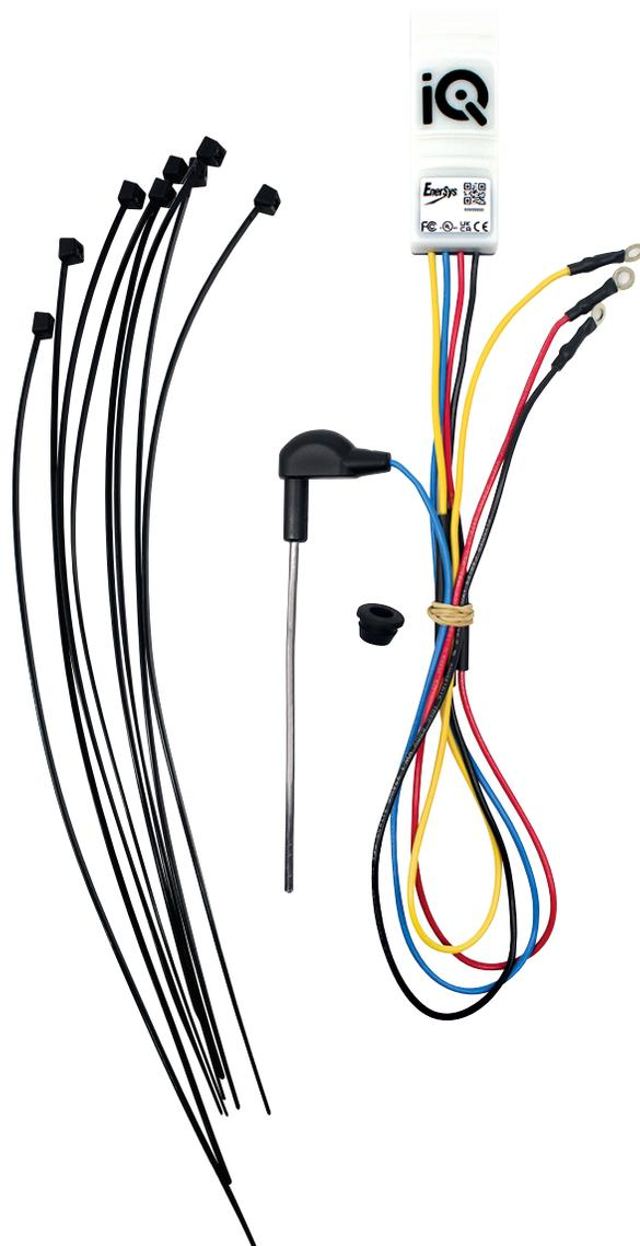
Der Batteriecontroller iQ Mini™ - 310S ist Batterielebensdauermonitor, der den Status in Echtzeit anzeigt und für den Einsatz mit 12-V- bis 80-V-TPPL-Batterien ausgelegt ist.
