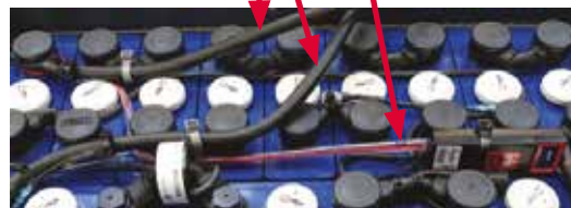
Conexiune CAN la PN2
