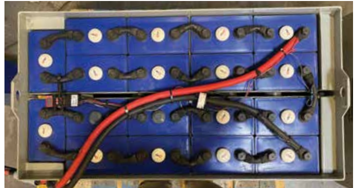
Slika 7: Konačno sklopanje uređaja Wi-iQ4 na policu za ćelije od 2 V
