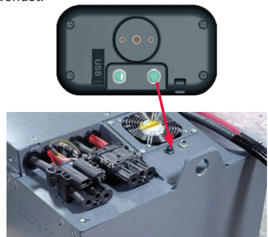
Anschluss an NexSys® TPPL ATP-BMS
