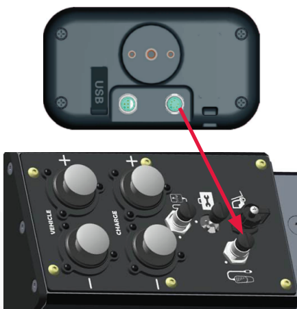
Anschluss an Nexsys® ION-BMS
