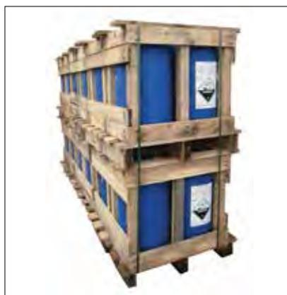
До использования пропитанные электролитом и заряженные батареи следует хранить в прохладном, сухом и чистом месте, вдали от источников тепла, оберегая от прямых солнечных лучей. В таких условиях пропитанные электролитом и заряженные элементы могут храниться до 2 лет.
