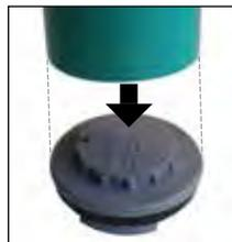
2. Присоедините ручной насос к бочке с электролитом. Удостоверьтесь, что насос плотно привинчен к пластмассовой бочке. Удельный вес электролита для заливки (при 20°C) составляет 1,280.
