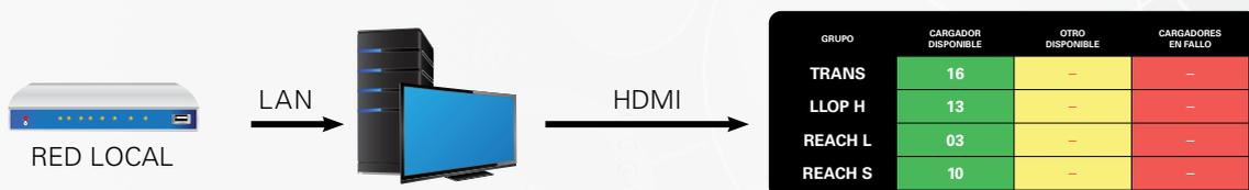
Se instala un armario de red local en la sala de carga. Los cargadores se conectarán por Ethernet a la red del cliente, con un PC conectado a la misma red. Los dispositivos serán reconocidos sin necesidad de conexión directa a este PC. La pantalla FiFo (First in, First out) se conectará directamente al PC como un segundo monitor. Si no se requiere pantalla FiFo (First in, First out), se puede instalar un PC en una ubicación diferente, pero siempre en la misma red.
