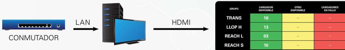
Se instala un armario de red local en la sala de carga. Se requiere un PC y un conmutador de red para conectar todos los cargadores al PC y que el sistema sea funcional. La pantalla FiFo (First in, First out) se conectará directamente al PC como un segundo monitor. Opcionalmente, este PC se puede conectar a Internet para acceder a él de forma remota.
