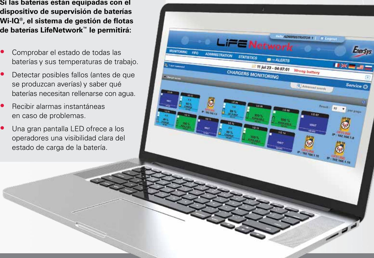
El sistema de gestión de flotas de baterías LifeNetwork™ ofrece dos opciones de instalación. El programa se puede instalar en un PC local conectado a todos los cargadores o en un servidor virtual con los cargadores conectados a la red correspondiente.
