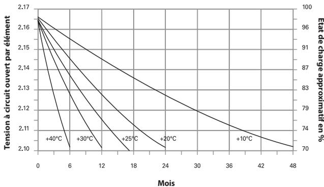
**2.1.2.** La durée maximale de stockage entre deux charges d'entretien et les intervalles de contrôle de la tension à vide (OCV) à respecter sont :
