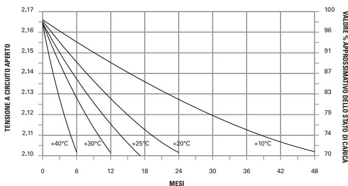
**2.1.2.** È richiesto il periodo di immagazzinamento massimo prima di una carica di rinfresco e gli intervalli di controllo OCV raccomandati sono:
