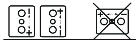
Jede/r Monoblock / Zelle wird mit Befestigungselementen für Pole/Verbinder geliefert. Der Pluspol ist auf jedem/r Monoblock / Zelle mit dem Symbol „+“ gekennzeichnet. Bauen Sie die Batterien ein, wie in der Anleitung und/oder Layout-Zeichnung beschrieben ist. Setzen Sie die Batterien korrekt ein und achten Sie dabei auf die richtige Polarität der Pole.
