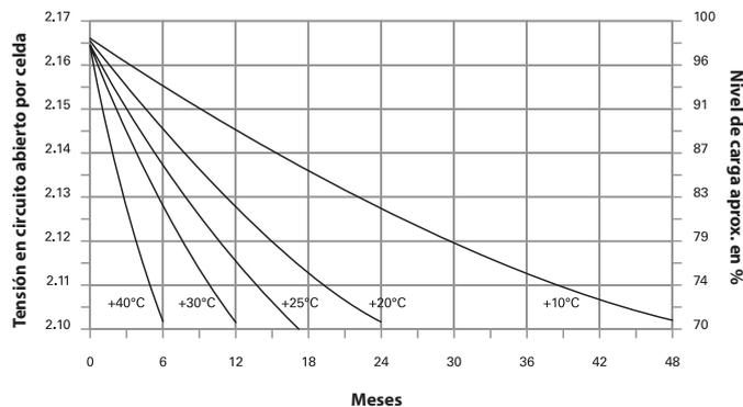
**2.1.2.** Los tiempos máximos de almacenamiento antes de que necesite una carga de mantenimiento y los intervalos recomendados de comprobación de la tensión en circuito abierto son:
