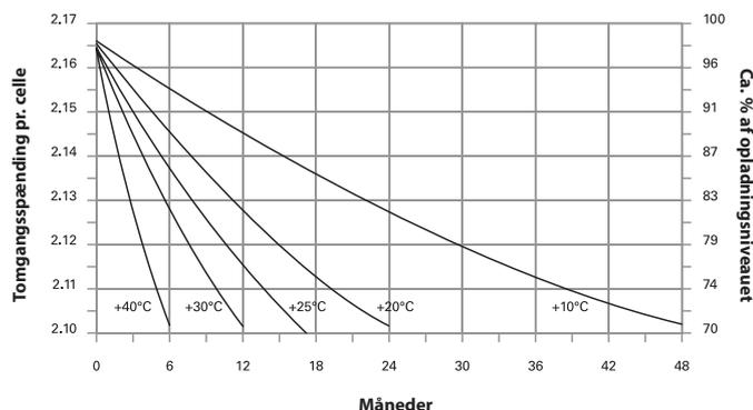
**2.1.2.** Der gælder følgende for den maksimale opbevaringslængde, før det er nødvendigt med genopladning, og de anbefalede intervaller for kontrol af tomgangsspændingen er:
