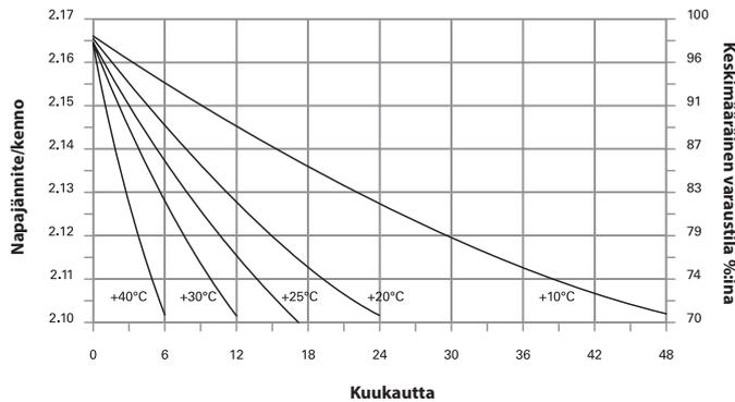
**2.1.2.** Pisimmät sallitut säilytysajat ennen kuin virkistysvaraus on suoritettava sekä suositellut napajännitteen tarkistusvälit ovat seuraavat:
