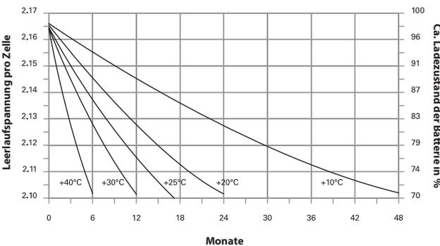
2.1.2. Maximal erlaubte Lagerungsdauer vor einer Auffrischungsladung sowie empfohlene Intervalle zum Prüfen der Leerlaufspannung OCV sind:
