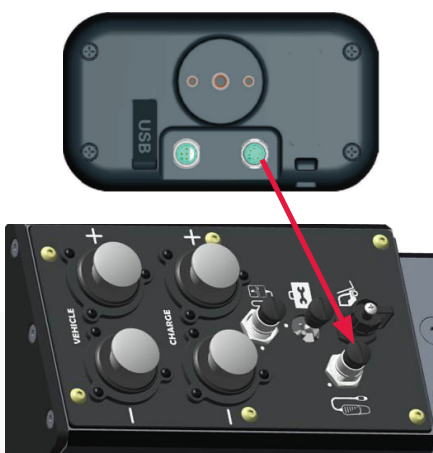
Conexión a NexSys® ION-BMS
